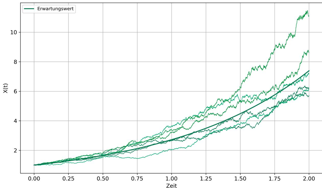
**Abbildung 2:** Verschiedene Realisierungen der Geometrischen Brownschen Bewegung mit  $\mu = 1$ ,  $\sigma = 0.2$  und  $X(0) = 1$ . Es  $N = 3000$  und  $T = [0, 2]$ .
